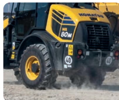
Hydrostatisk drivlinje med 40 km/t-begrensing (ekstrautstyr)
