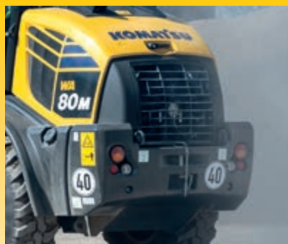
Grovribbet radiator, kan leveres med reversibel vifte som ekstrautstyr
